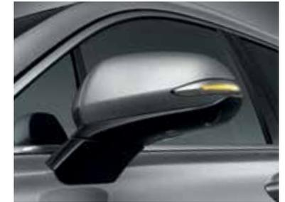
Außenspiegel mit integrierter Blinkereinheit
