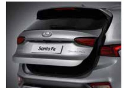
Kofferraumassistent (automatisches Öffnen und Schließen der Heckklappe)
